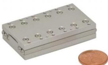
XLS-1 系列是由超声波压电马达驱动的精密切线性平台。这种平台将高速定位与纳米精度相结合。Xeryon 的超声波压电马达确保平台的长寿命、无噪音、无振动地使用。此外，自锁压电马达在断电时保持住平台的原有位置。来自运动产生的热很小，从而铸就了稳定的纳米定位系统。XLS-1 可用于测量应用，例如用于零件的校准或样品的修正。
