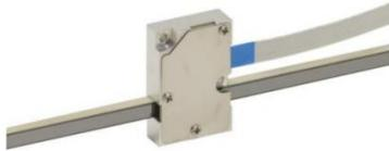
XLA-1 闭环微线性执行器在重量、尺寸和精度方面都是世界一流的。执行器由 Crossfixx™ 超声波压电电机驱动，允许一个非常紧凑的设计，可变速度能达到 200 mm/s 和总重量小于 6 克！XLA-1 闭环系统有一个集成的编码器，分辨率分别为 1250、312 或 78 nm。两个电缆位置是可能的（顶部或侧面）和一个广泛的杆长度范围可用，允许冲程长度从 5 毫米到 185 毫米！
