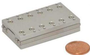
XLS-3 系列是由超声波压电马达驱动的精密切线性平台。这些平台将高速定位与纳米精度相结合，在较小体积的情况下达到高力矩输出。Xeryon 的超声波压电马达确保您长寿命、无噪音和无振动运行。此外，自锁压电马达保证平台在掉电时锁住平台的位置。来自运动产生的热很小，从而铸就了稳定的纳米定位系统。
